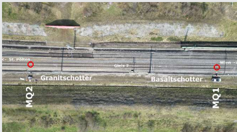
1: Anordnungen der Messquerschnitte entsprechend der Kilometrierung MQ1 mit Basaltschotter und MQ2 mit Granitschotter im Gleis 7 auf der Neubaustrecke Wien – St. Pölten
